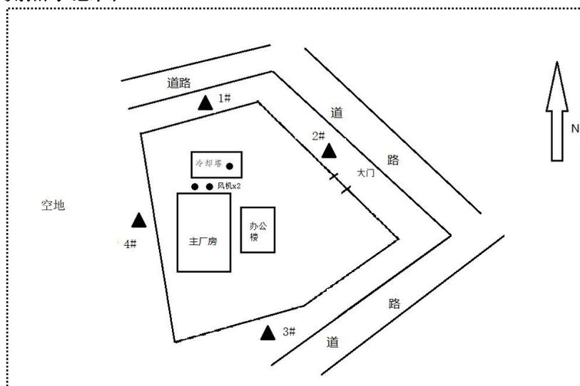
图例说明：▲-噪声检测点；●-噪声源。
