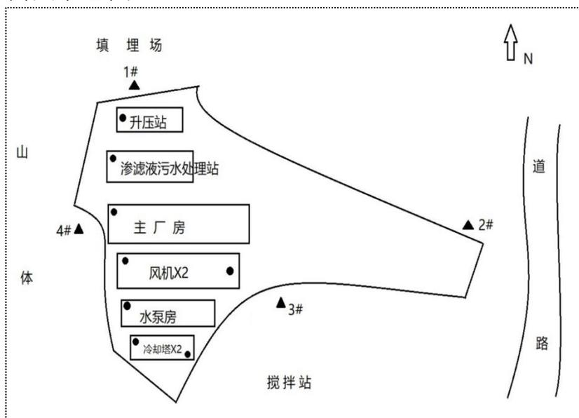
图例说明：▲-厂界噪声检测点；●-噪声源。
